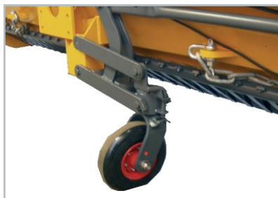
Justerbart stödhjul för avställning. Enkel på och avmontering av spridaren.
