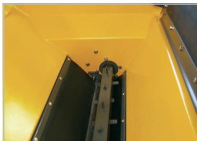
Epoke doseringssystem: Omrörare som mal ner eventuella klumpar, samt utläggarsvals fördosering.
